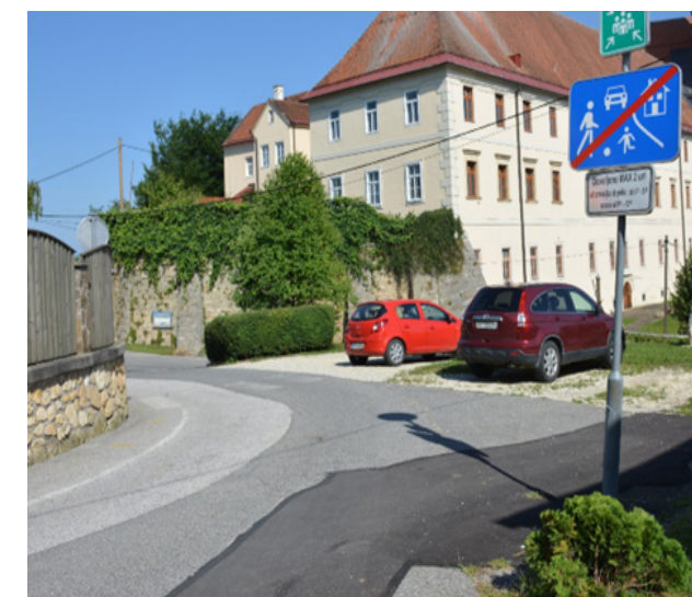
Slika 12: Ureditev v neposredni bližini vrtca in osnovne šole zaradi nepreglednega ovinka in odsotnosti zaščitnih elementov predstavlja varnostno tveganje v prometu.
